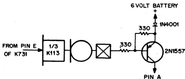
**POWER FAILURE SWITCH FOR EMERGENCY BATTERY**
